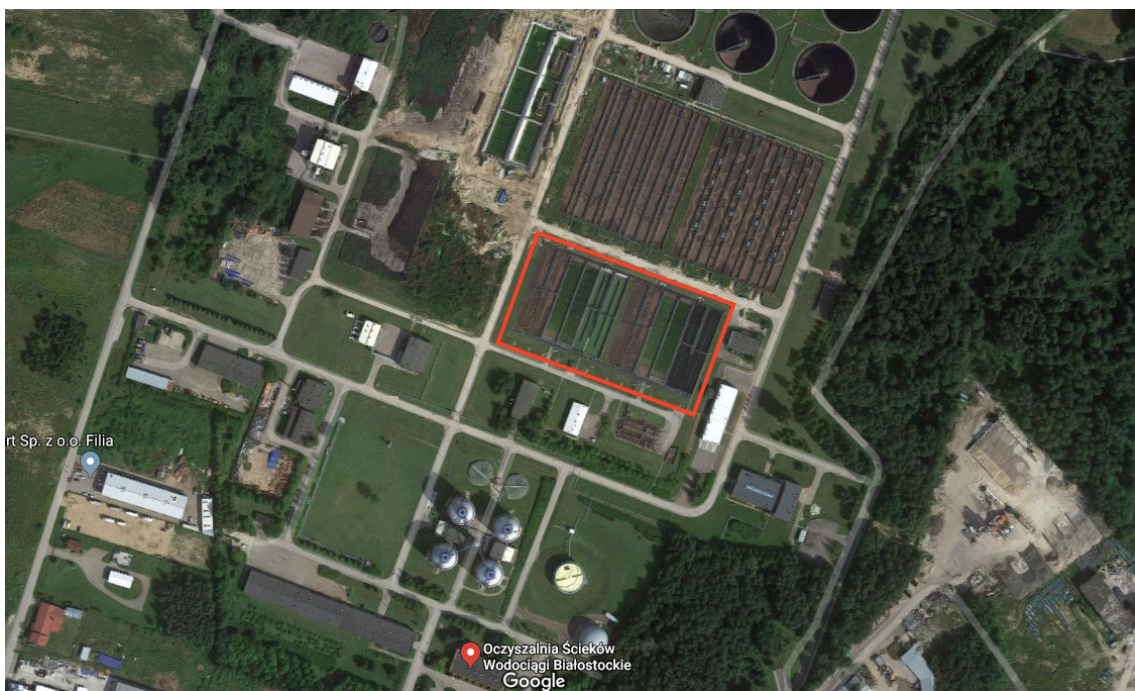
Rys. 8. Osadniki wstępne oraz komory prenityfikacji i komory defosfatacji z kanałem dopływowym i kanałem odpływowym ujęte ekspertyzą
