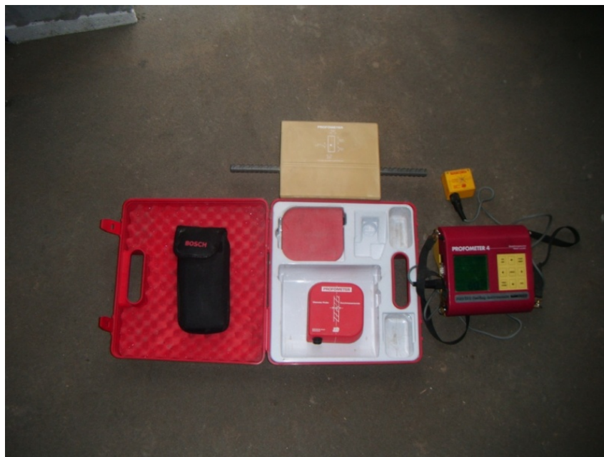
Rys. 11. Urządzenie służące do detekcji zbrojenia i sprawdzenia poprawności otulenia
