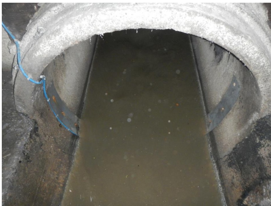
Rys. 14 Zamontowana sonda pomiaru prędkości ścieków
