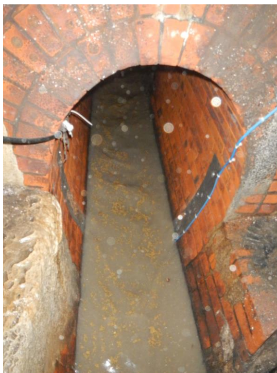
Rys. 15 Kalibracja urządzenia pomiarowego, zamontowany przepływomierz w punkcie nr 7
